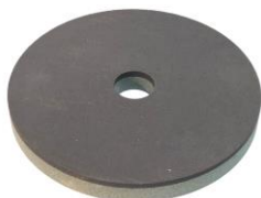
Круг из кубического нитрида бора на керамической связке шлиф 40/28 150x20x32x5 1A2 СИТ30 100 Q V.
